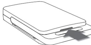
2. Wechseln Sie die Batterie. Verwenden Sie ausschließlich Batterien des Typs CR2032.
