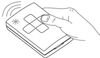
Blinkt die LED während des Sendevorganges und noch ca. 3 Sekunden nach Loslassen der Sendetaste, wechseln Sie bitte die Batterie.
