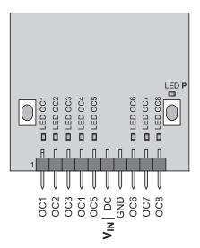
**RCD21E5008A01** 3.0 V - 8.0 V **RCD21E5008A03** 8.0 V - 36.0 V
